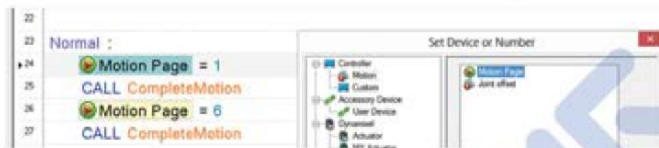
Для того чтобы в основной программе использовать заранее разработанное движение, необходимо воспользоваться программируемым блоком Motion Page. В параметрах данного блока следует установить номер строки Motion-файла, отвечающей за необходимое движение.
