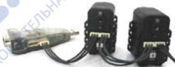
Преобразователь USB2Dynamixel не передает напряжение питания на подключенные к нему устройства, поэтому для запитывания сетевых устройств необходимо подать питание на последний элемент сети.
