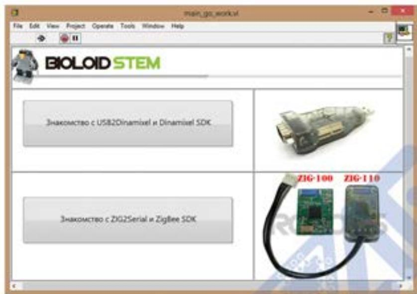
При переходе в меню «Знакомство с USB2Dynamixel и Dynamixel SDK» пользователю предлагается воспользоваться одним из режимов работы – «Проводной режим» для управления сервоприводами с помощью проводного канала связи или «Беспроводной режим» для управления сервоприводами с помощью интерфейса ZigBee.
