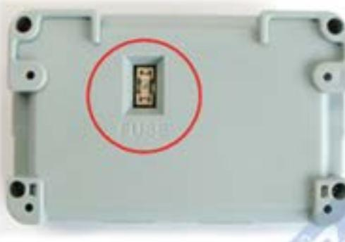
Плавкий предохранитель защищает внутренние цепи робота Bioloid от превышения допустимого значения потребляемого тока, как вследствие перегрузок, так и в случае возникновения короткого замыкания.
