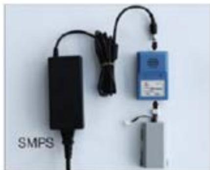
При включении зарядного устройства в сеть должна загореться красная лампочка зарядного устройства. В случае окончания процесса зарядки должна загореться зеленая лампочка.
