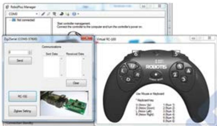
17. С помощью открывшегося виртуального пульта управления можно путем нажатия кнопок U, L, R и D управлять движением робота. Для этого необходимо, чтобы в контроллер робота была записана одна из тестовых программ, которую можно скачать с официального сайта ROBOTIS или скачать из Help среды разработки RoboPlus.
