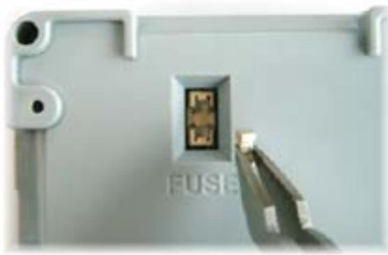
Замена плавкого предохранителя должна осуществляться при выключенном питании программируемого контроллера СМ-530 и полностью отключенного от сети. Помимо этого необходимо отключить от контроллера аккумуляторную батарею и все внешние устройства робота.
