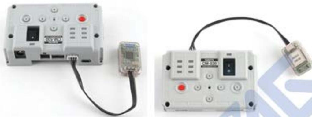
Подключение модулей ZigBee или Bluetooth к программируемому контроллеру CM-530 осуществляется с помощью порта «Communication Device Connection Jack».
