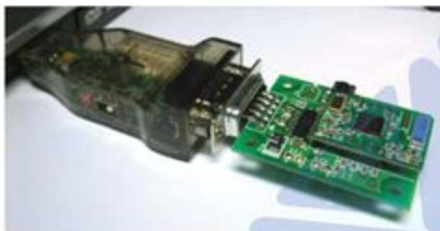
Устройство USB2Dynamixel – это универсальный преобразователь интерфейсов USB персонального компьютера в последовательный интерфейс, применяемый в сервоприводах, контроллерах и беспроводных модулях ROBOTIS.
