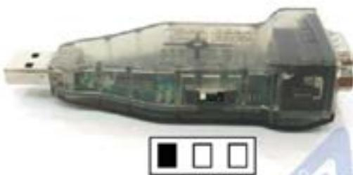
При помощи трехпроводного шлейфа необходимо подключить устройство к порту 3Р преобразователя USB2Dynamixel.
