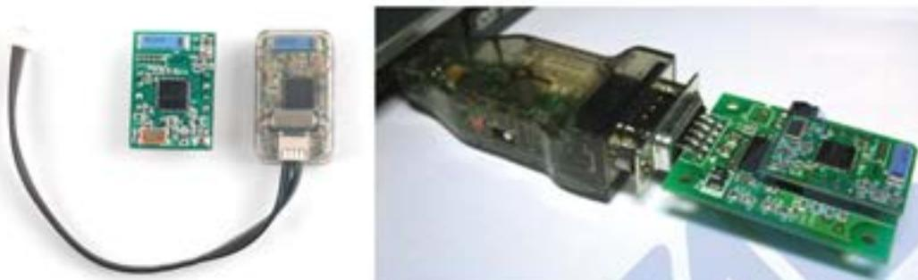
Комплект беспроводных модулей ZigBee состоит из трех устройств – два модуля ZIG-100/ZIG-110A представляют собой пару устройств, осуществляющих передачу данных друг другу, третий модуль ZIG2Serial предназначен для передачи данных на персональный компьютер.
