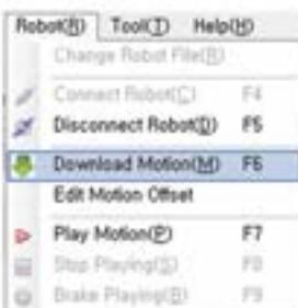
Для того чтобы загрузить файл движений робота в память контроллера, воспользуйтесь меню Download Motion вкладки Robot. Очень важно помнить о том, что файл движений (Motion-файл) должен загружаться в память робота до загрузки файла управляющей программы (Task-файл). Нарушение данной последовательности может привести к сбою процесса компиляции основной программы.
