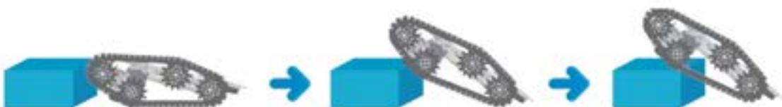
Конструкция шасси робота состоит из гусеничных траков, расположенных под достаточно большим углом к направлению движения, благодаря чему робот может преодолевать препятствия с высотой не менее высоты подъема гусеничных траков.
